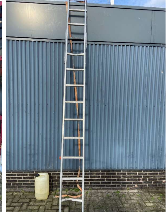
Afbeelding 5 Beschadigde ladder en verkeerd ladderdeel
